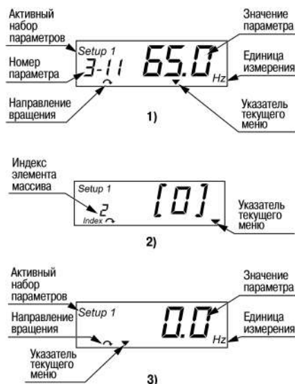
Рисунок 3.5 – Индикация на ЖКИ (1) параметров при настройке; (2) индекса элемента массива при настройке; (3) рабочего меню Статус
